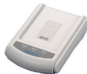
Leitor RFID AP 340K leitor de mesa de rfid (varias frequências) Peso: 1,640kg
